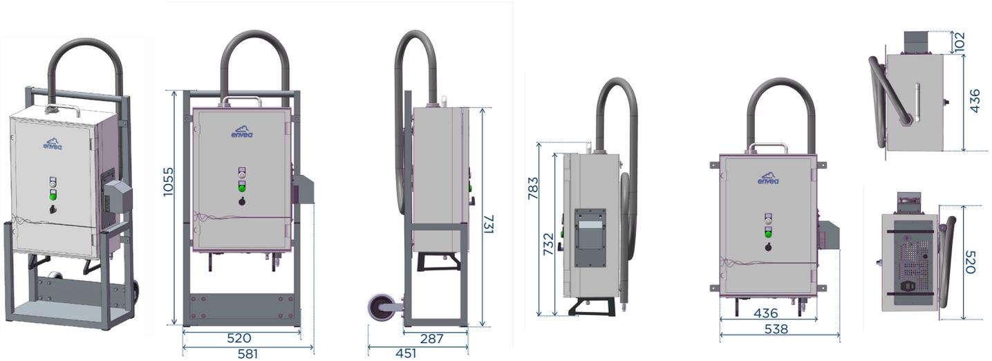
SC-5000系统的移动式（带轮推车）和固定式版本。尺寸以mm为单位。
