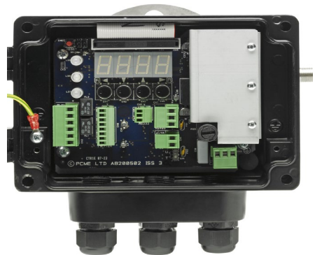
PC 通过可选的 RS232 或 RS485 输入连接器 (RS485 可选) 连接到接收单元
