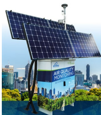
Figure 23 : Appareils de mesure de surveillance de la qualité de l'air alimenté par une station solaire
