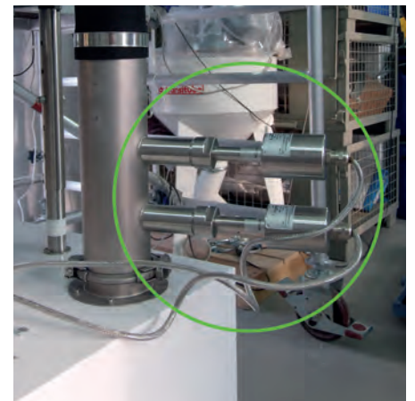
安装在气力输送或自由落体管道上
