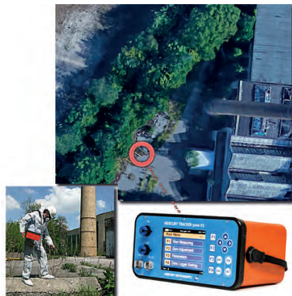
工厂汞泄漏检测
