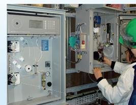
用 PA-2(左)在线测量浓缩(50%)烧碱中的汞, 样品通过一个特别设计的稀释系统(右)。
