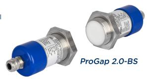
Durch die berührungslose Leveldetektion können Grenzstände in den Behältern detektiert und Mischprozesse optimiert werden. Auf Grund der Befüllstromerkennung detektiert der ProGap 2.0-BS selbst während eines Befüllvorgangs, der den Strahlengang unterbricht, zuverlässig, ob ein Grenzstand erreicht ist. Die Reichweite des ProGap 2.0-BS beträgt 0,1 bis 25 m.
