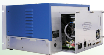
后面板的滑动抽屉设计便于操作和维护
