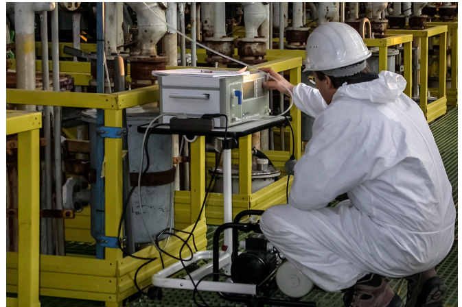
运行中的MC-3000: 汞监测系统的校准
